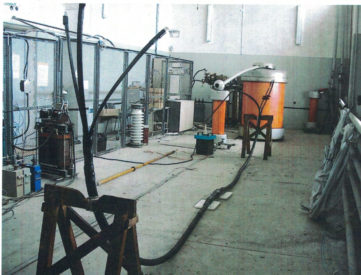
Образец с муфтами при испытании постоянным напряжением
