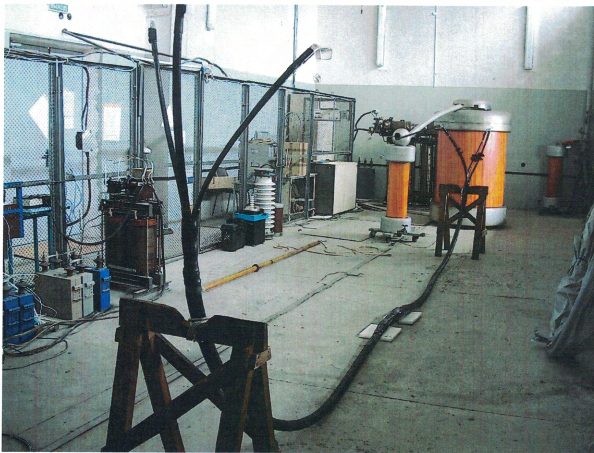
Образец с муфтами при испытании постоянным напряжением
